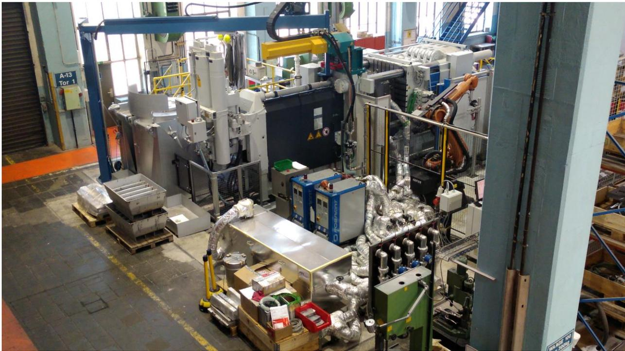
**Abbildung 14:** Gesamtaufnahme der LKR-Druckgussanlage mit dem Polymer-PCM-Speicher vorne, den Heiz-Kühl-Geräten (blau-weiß), Anlagenmesstechnik, Druckgussmaschine, Schmelzofen, Roboter und den isolierten Leitungen.
