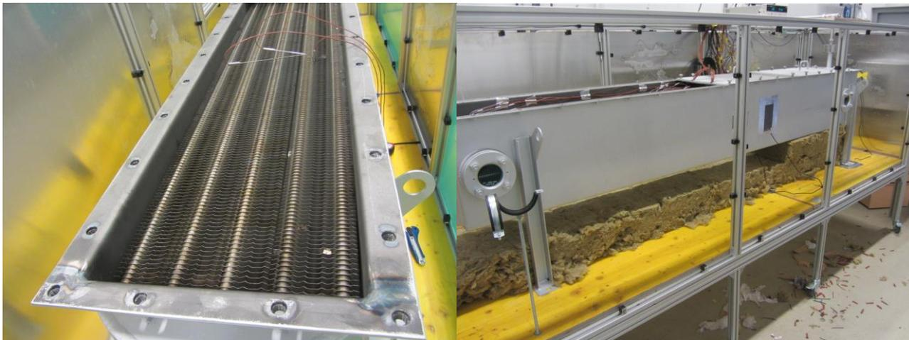
**Abbildung 47:** Laboraufbau des Speichers im neuen Speicherlabor des AIT vor der Befüllung mit PCM und vor der thermischen Isolierung.
