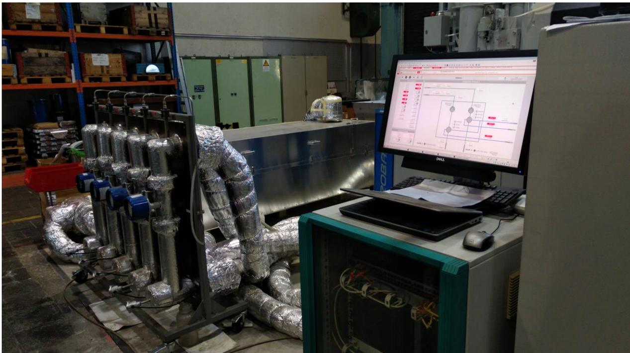
**Abbildung 15:** Detailaufnahme der LKR-Anlage mit dem Monitor des Leitsystems (rechts,) Anlagenmesstechnik (links), dem Polymer-PCM-Speicher (Mitte, hinten) sowie den isolierten Leitungen.
