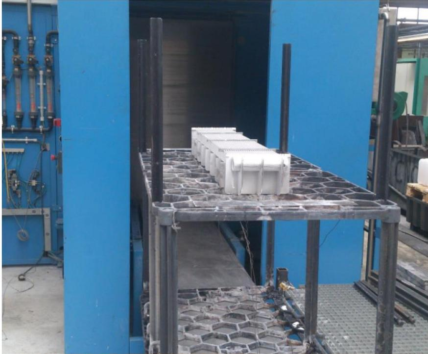
Abbildung 5: Entwickelter Wärmetauscher mit Lötrahmen (Quelle: RF)
