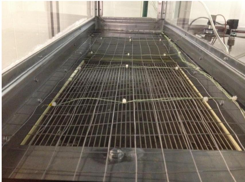
Abbildung 20: Lufttemperaturmessung nach Austritt aus den Wärmetauschern anhand von Temperaturgitter (Quelle: ViF)
