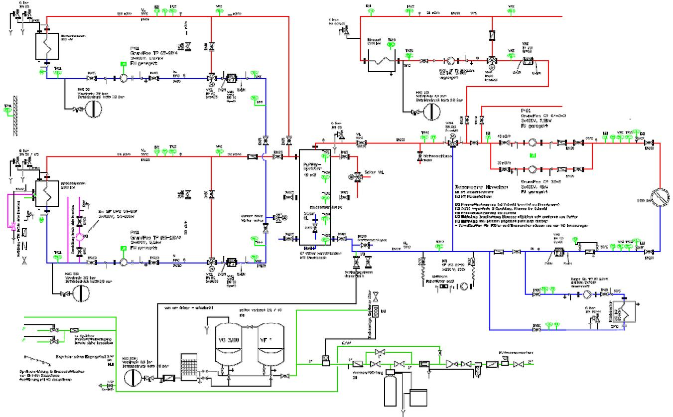
Bild 2 Hydraulikplan Heizwerk Mattsee (Quelle: nahwaerme.at)
