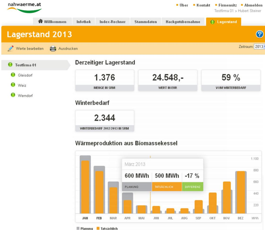
Bild 4 Beispieldiagramm Lagerstandsbewertung und Wärmeproduktion aus naida (Quelle: nahwaerme.at)
