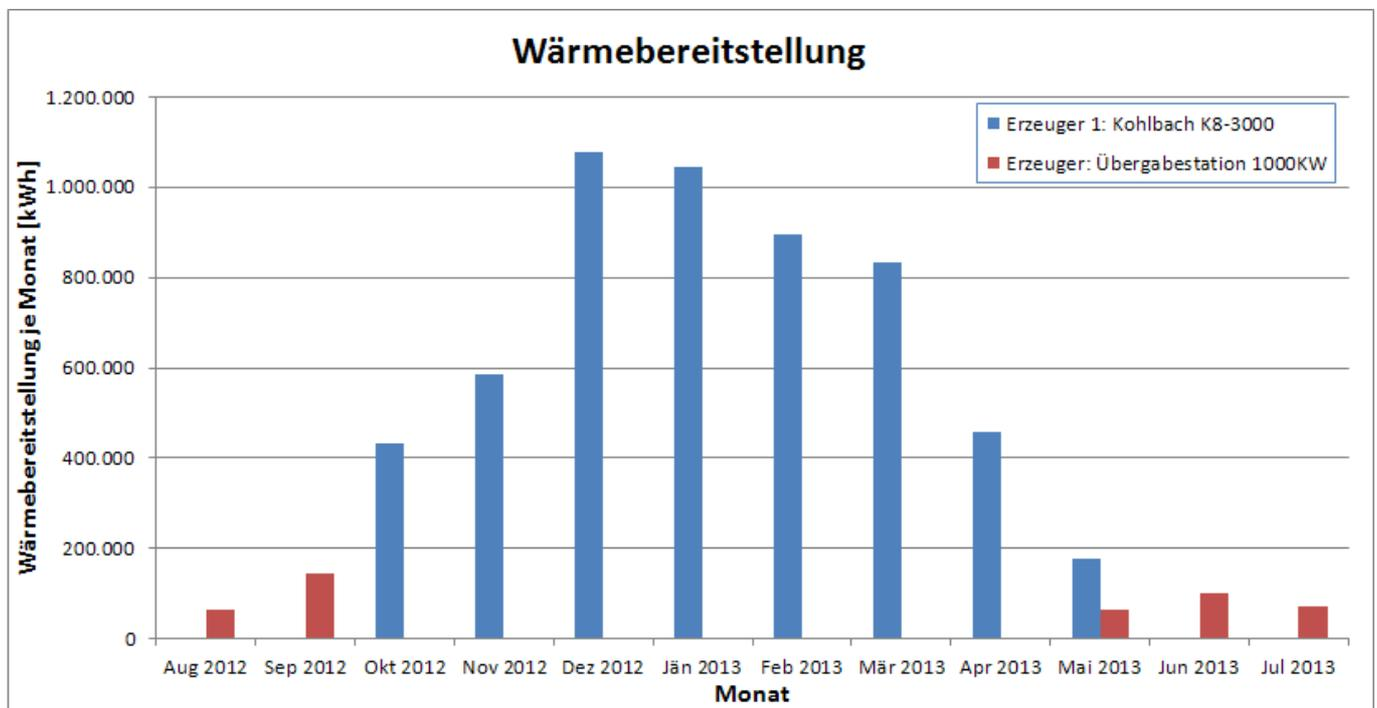
Bild 3 Grafische Darstellung der Wärmebereitstellung des Heizwerks Stainz (Datenquelle: nahwärme.st GmbH)
