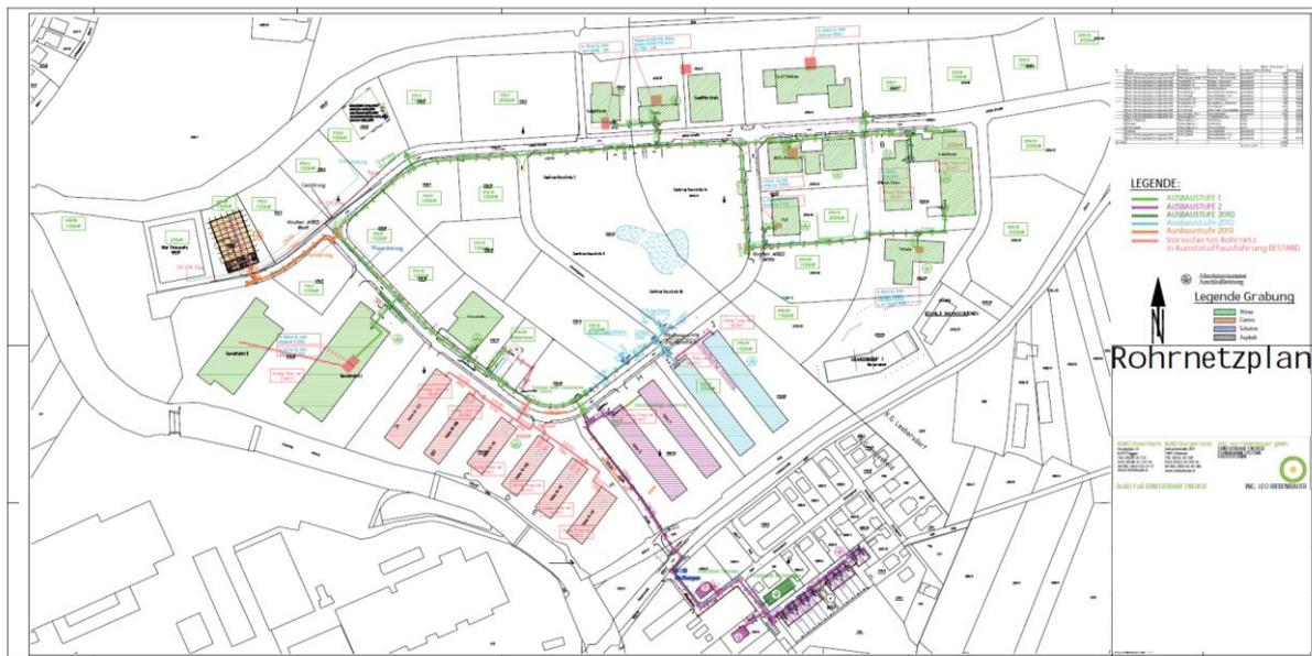
**Abbildung 4.4: Übersicht des Rohrnetzes der Fernwärme im Gewerbepark**
