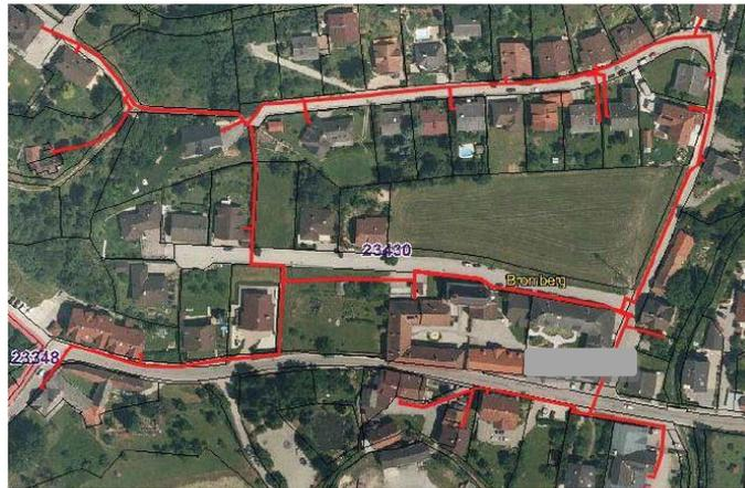
**Abbildung 5.2: Fernwärmenetz Kommune**
