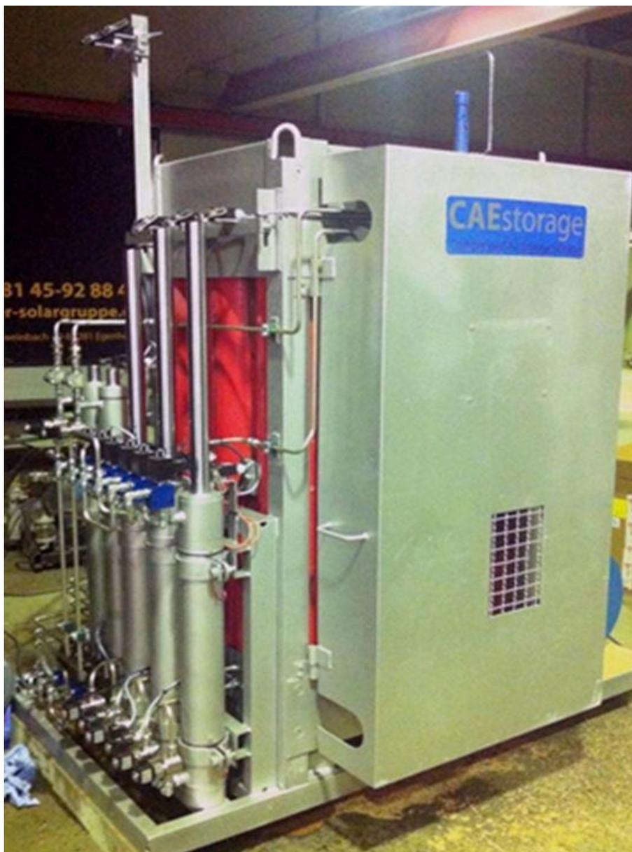
Abb. 8: Prototyp eines Energiespeichers für erneuerbare Energie, CAEStorage GmbH (CAEStorage GmbH, 2015)
