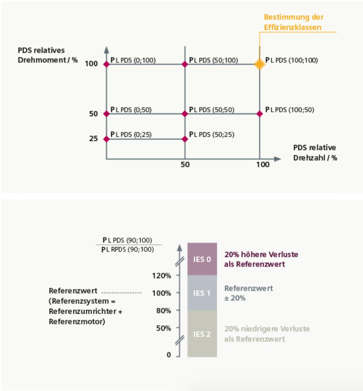
Abb. 16: Effizienzklassen von Antriebssystemen (Siemens AG, 2015b)
