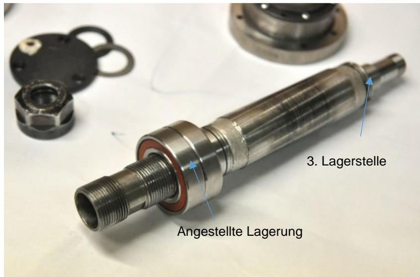
Abbildung 38: Ausgebauter Läufer des Spindeltriebs GDZ-80-2.2 A mit Lagerstellen
