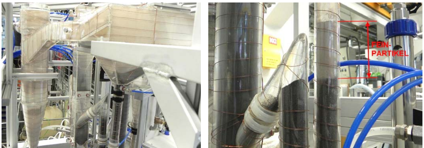
Abbildung 3: Abscheider des Kaltmodells (links) & abgeschiedene Partikelfraktion (rechts)
