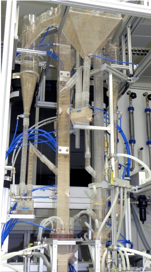
Oberer Teil des neuen Kaltmodells mit Schwerkraftabscheider und Zyklone
