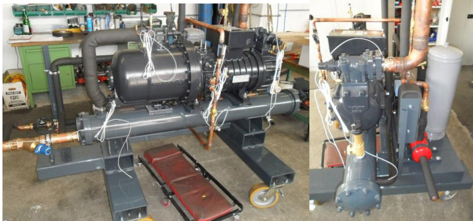
Abbildung 15: Aufbau der Wärmepumpe, Produktionsphase
