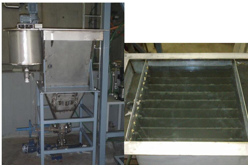
Abbildung 12: Seitenansicht (links) und Draufsicht (rechts) des eingesetzten Schrägklärers
