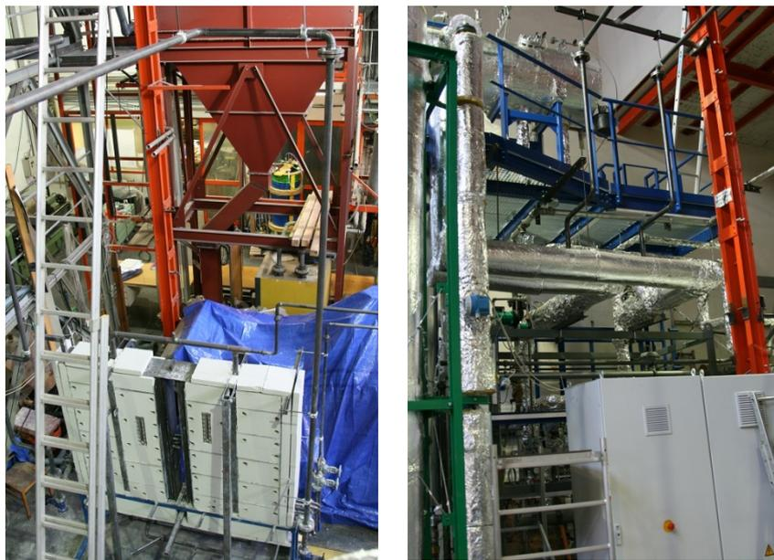
**Abb. 3.7: Umsetzung des Zwei-Kammer-Regenerators im Labor der TU-Wien**
