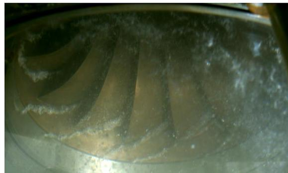
Sehr stark ausgeprägte Kavitation bei  $\sigma = \text{ca. } 0.15$
