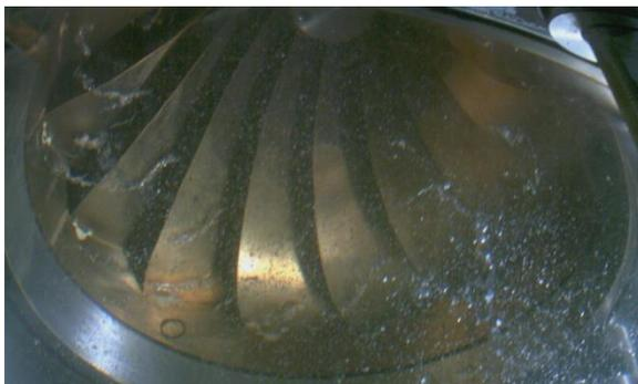
Ausgeprägte Kavitation bei  $\sigma = \text{ca. } 0.15$
