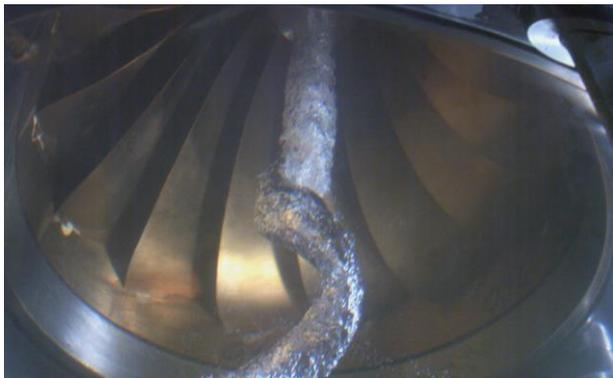
Ausgeprägte Kavitation bei  $\sigma = \text{ca. } 0.12$  (Laufschaufeln noch immer kavitationsfrei)
